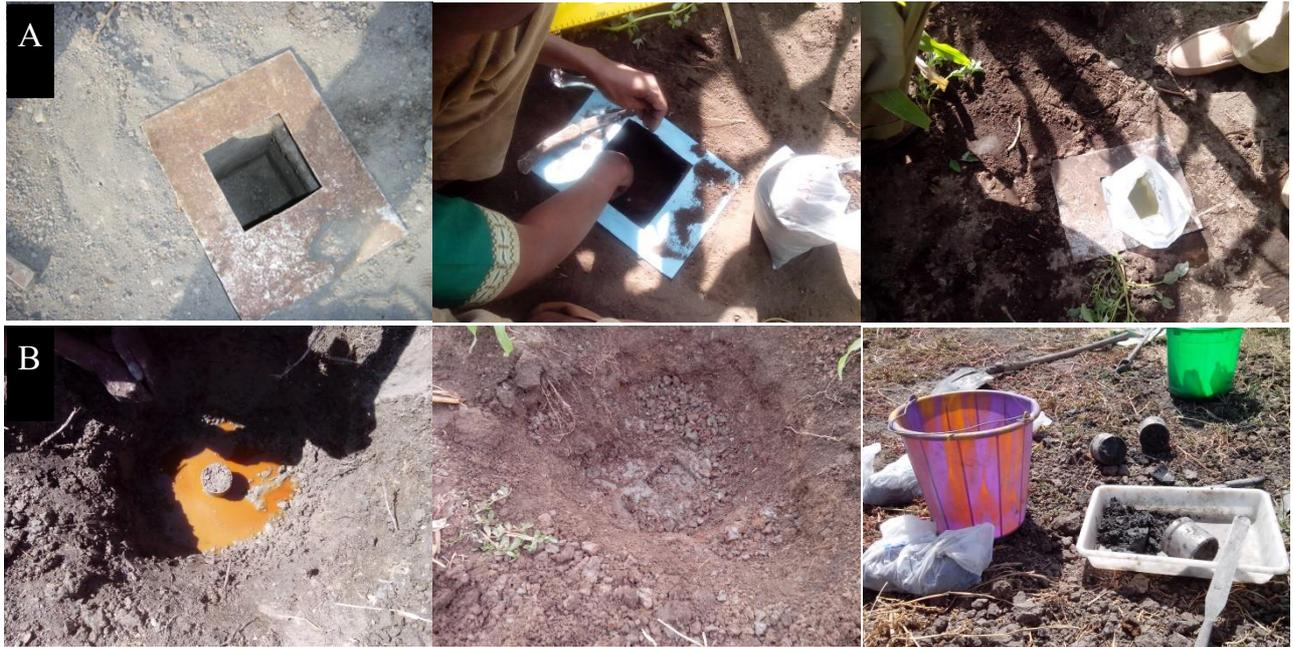
Figure 15: Etapes de prélèvement de la densité apparente A : « à eau », B : au cylindre.
