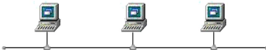
Les réseaux en bus sont **simples**, peu coûteux, facile à mettre en place et à maintenir. Si une machine tombe en panne sur un réseau en bus, alors le réseau fonctionne toujours, mais si le câble est défectueux alors le réseau tout entier ne fonctionne plus. Le bus constitue un seul segment que les stations doivent se partager pour communiquer entre elles.
