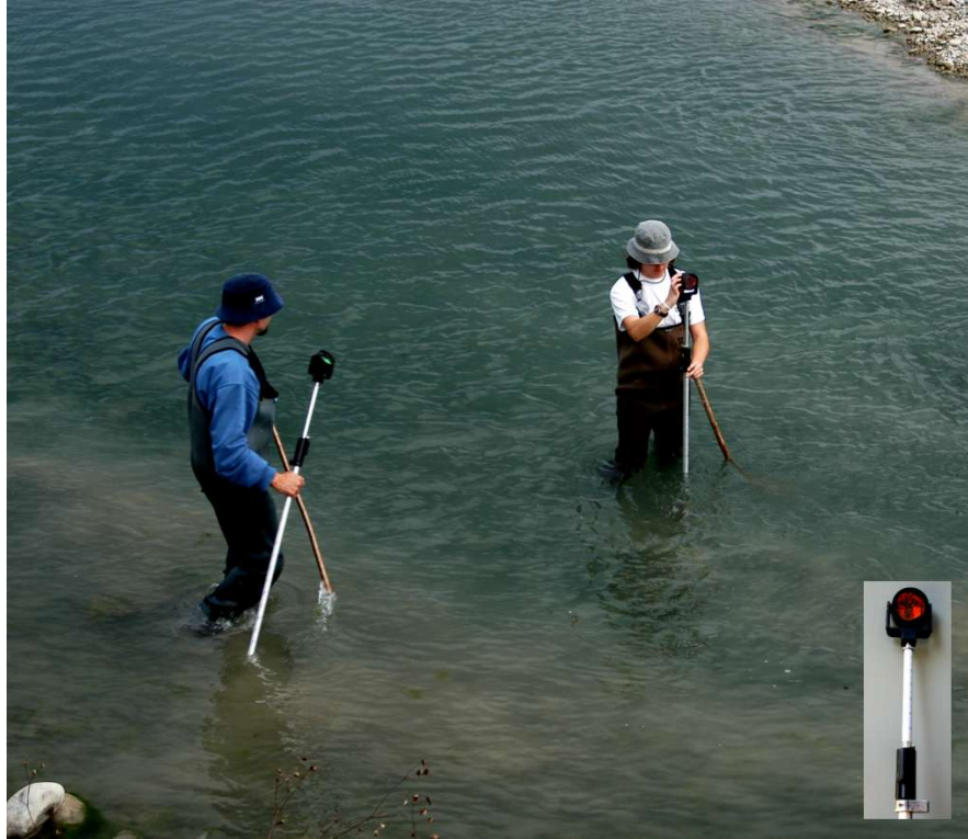
FIG. 2.5 - Mesure de la topographie immergée de la rivière ; détail d'un prisme.
