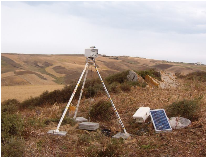
Figure 2.7. Vue du récepteur du scintillomètre installé en date du 31 mai 2006.
