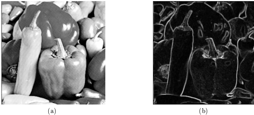
FIG. 3.3: Exemple d’image de gradient. (a) Image initiale. (b) Gradient morphologique de l’image (a) selon un élément structurant carré de taille 3 \times 3 . Les contours des objets correspondent aux plus fortes valeurs de gradient.
