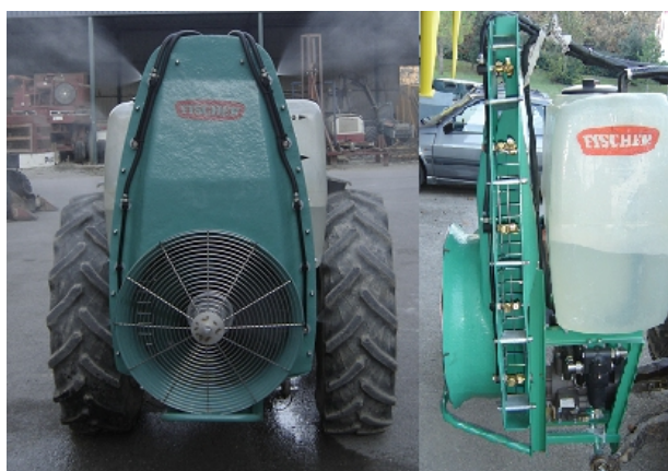
FIG. 3.5 – Pulvérisateur à jet porté utilisé dans les essais
