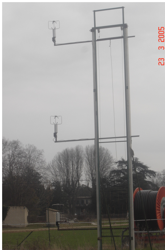
FIG. 3.7 – Anémomètre pour l'enregistrement de la température et des 3 composantes de vitesse du vent
