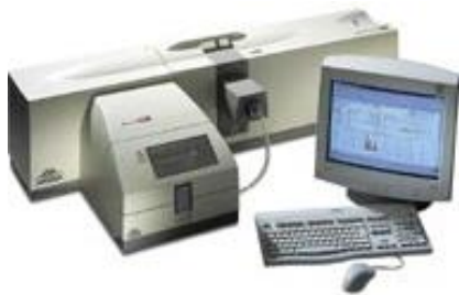
Figure 5 : Granulomètre de laboratoire. 📖 MALVERN
