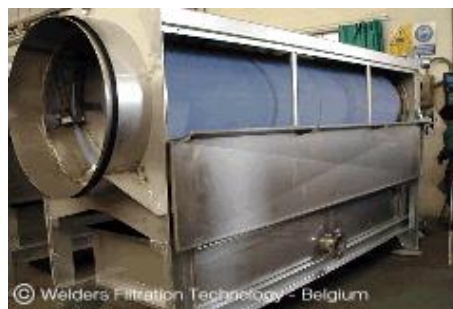
Figure 22 : Tables d'égouttage & tambour épaisseur.
