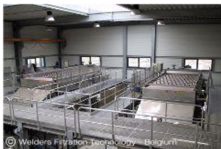
Figure 22 : Tables d'égouttage & tambour épaisseur.
