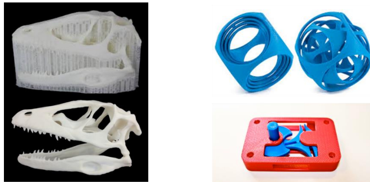
Figure. 37. Exemples de pièce nécessitant la présence de supports d'impression : à gauche pièces avec de nombreux portes à faux ; à droite pièce avec des zones séparées
