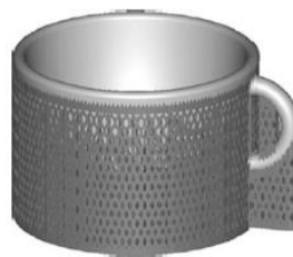
c. Supports pour un procédé de Powder Based Fusion
