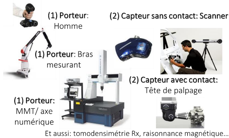
Figure. 3. Exemples d'équipement de numérisation 3D
