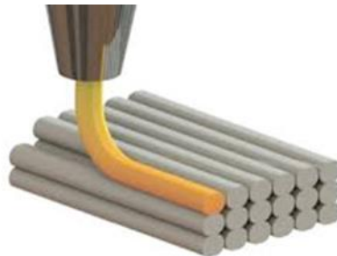
Figure. 36. Représentation schématique d'un cordon en phase de dépôt en sortie d'extrusion
