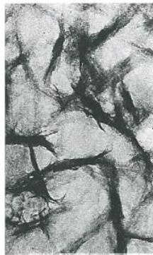
*Figure 1.7.1.1 Cliché MEB des nanofilaments d'Alumine[70]*
