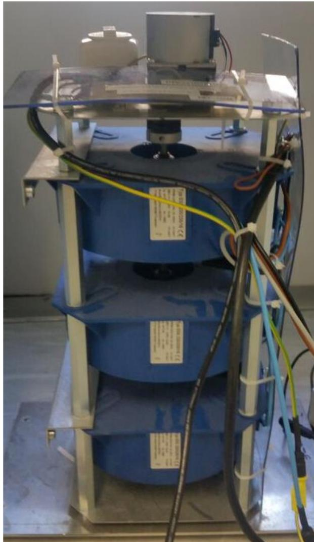
Figure 20 : Transformateur variable 11kVA, 230V, 50...60 Hz
