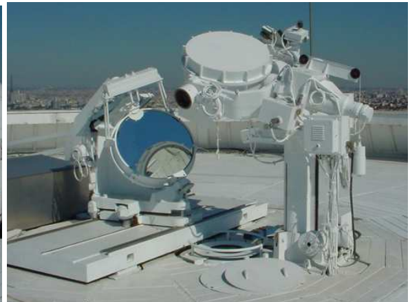
Les miroirs du coélostat en haut de la Tour captent la lumière du soleil
