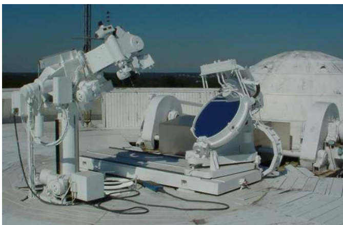
Les miroirs du coélostat en haut de la Tour captent la lumière du soleil
