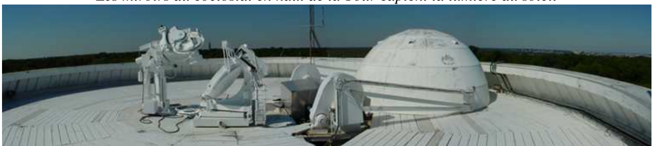
Les miroirs du coélostat en haut de la Tour captent la lumière du soleil
