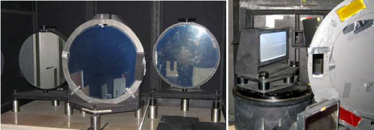
Objectifs de chambre et collimateur du spectrographe; réseau et filtres sélecteurs d'ordre
