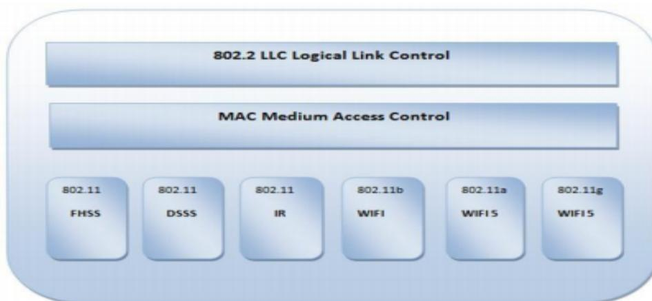
Figure 2.4: L'architecture en couches de la norme IEEE802.11[37].
