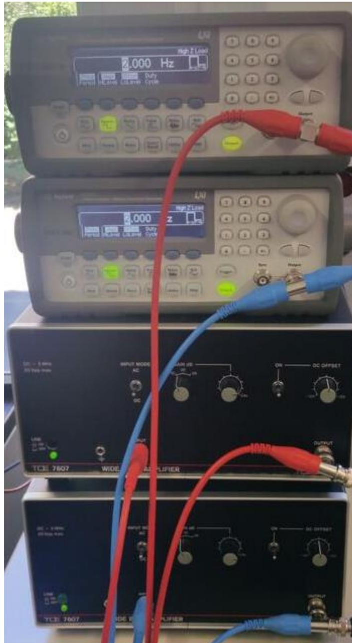
Figure 14 : Générateurs de fonctions et amplis 24 V
