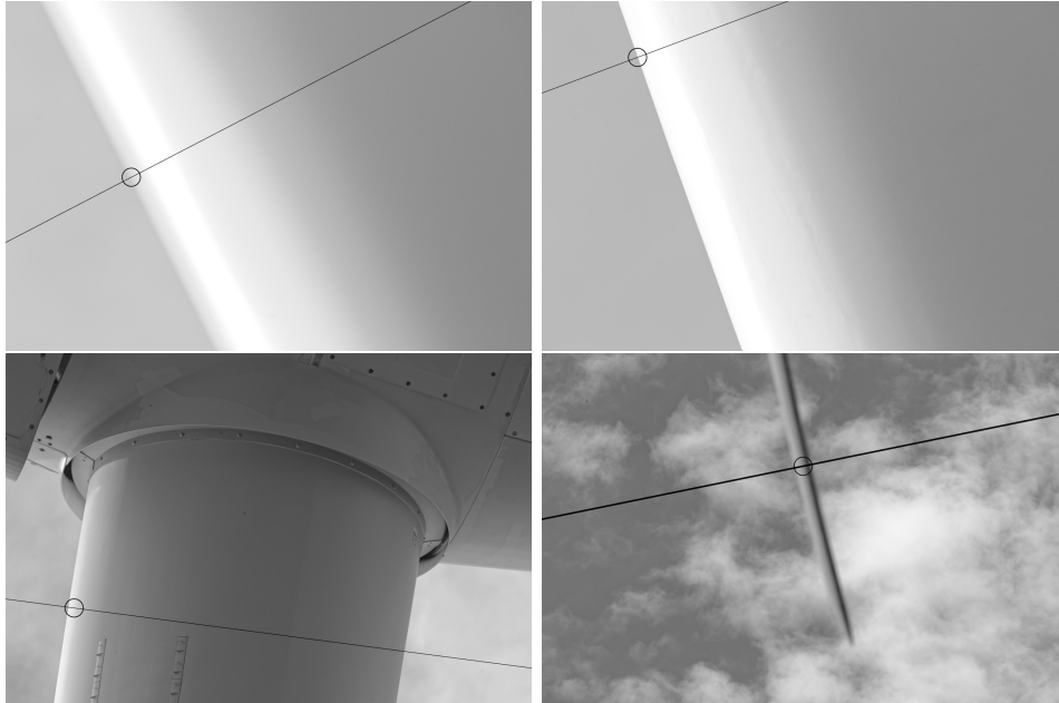
FIGURE 12. Résultat du calcul de la droite perpendiculaire à la pale et passant par l'interface ciel-pale pour plusieurs photos.
