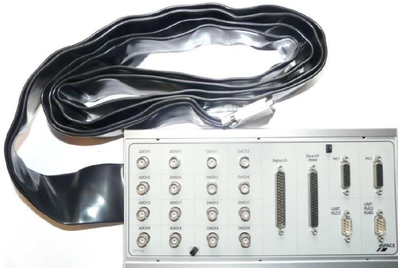
Figure 7. Illustration du Panneau de contrôle CP1104 (Les panneaux que nous disposons dans la salle de projet sont exactement les mêmes mais avec des Leds)
