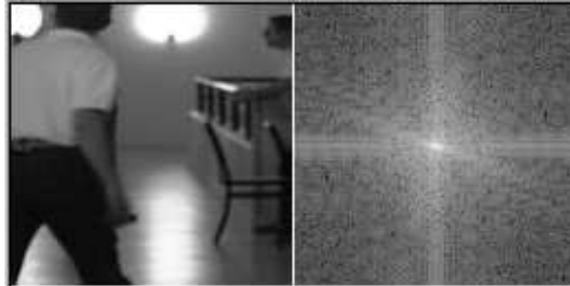
FIGURE 1.4 – Spectre d'une image réelle ( Couloir ).
