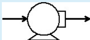
schématisation d'une pompe (ancienne norme)
