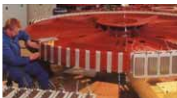
Rotor à pôles saillants bobinés Enercon
