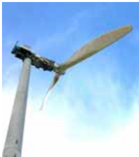
Rotor sous le vent (Vergnet 220 kW)
