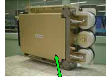
Onduleur de traction TGV Est (IGBT 1200A – 3300 V) MAS 1,16 MW
