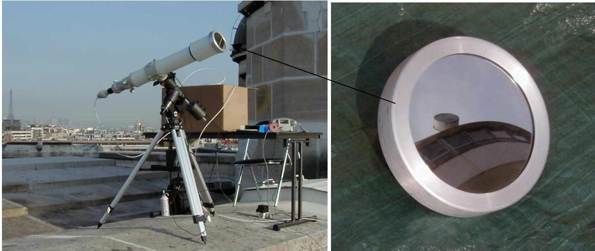
Lunette et filtre pleine ouverture transmettant 1/100 000 ème de la lumière Le filtre est fixé sur l'objectif d'entrée de la lunette
