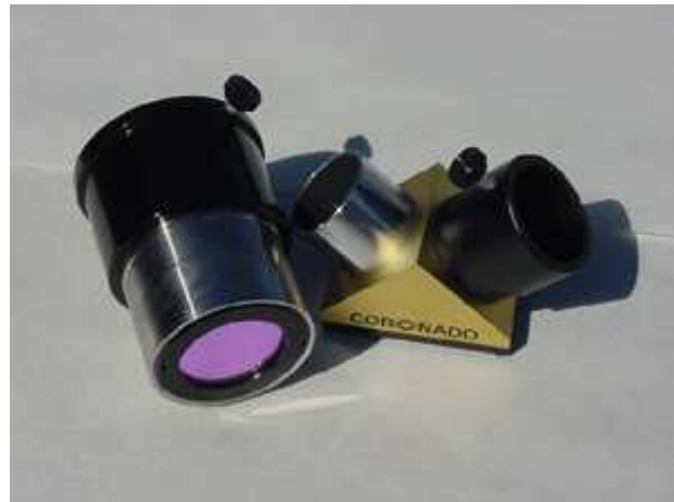
Le filtre Fabry Pérot « pleine ouverture » de Coronado et le dispositif de filtration porte oculaire : ces deux éléments sont indissociables
