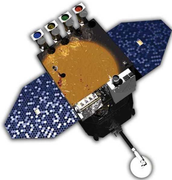
Radiohéliographe de Nançay, observant les rayonnements dans le domaine radioélectrique (ondes métriques), et Solar Dynamics Observatory (NASA), observatoire spatial en orbite géostationnaire tourné vers le soleil et observant les rayonnements UV arrêtés par l'atmosphère.
