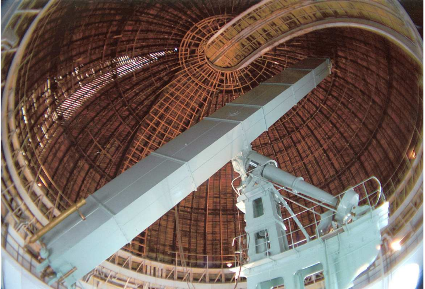
Figure 2 : Grande Lunette double de l'Observatoire de Meudon (18 mètres de longueur), ultime aboutissement de trois siècles de perfectionnements des lunettes de Galilée et de Képler, et dont la technologie est abandonnée (chez les professionnels) depuis cent ans au profit des télescopes beaucoup plus puissants et compacts (document Obs. Paris).
