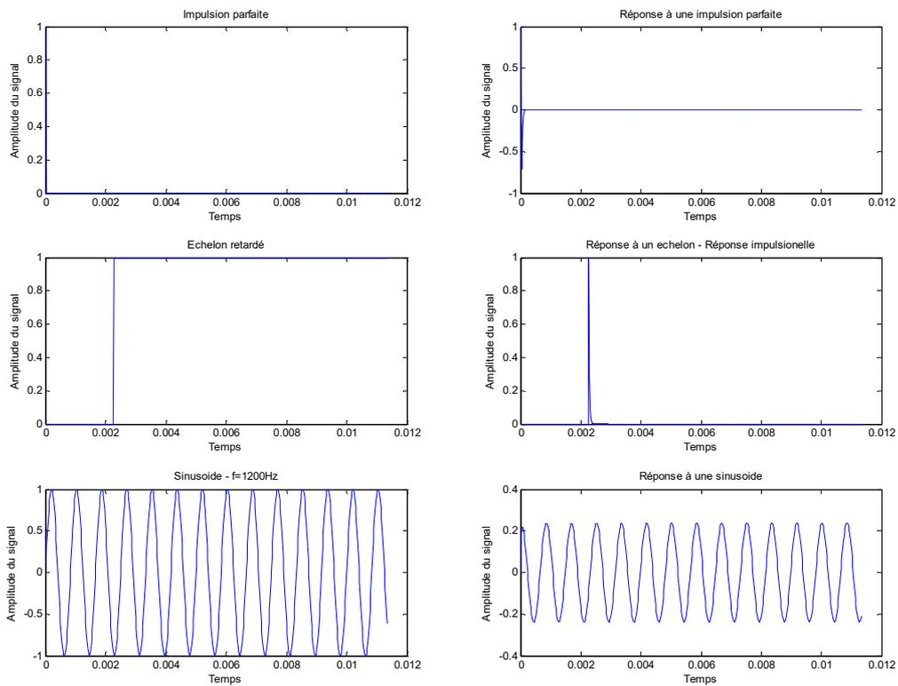
On a bien, comme attendu, une réponse impulsionnelle en exponentielle descendante et des signaux atténués. On remarque que le sinus est très atténué car sa fréquence est inférieure à la fréquence de coupure ( $1200\text{Hz} < 5\text{kHz}$ ).
