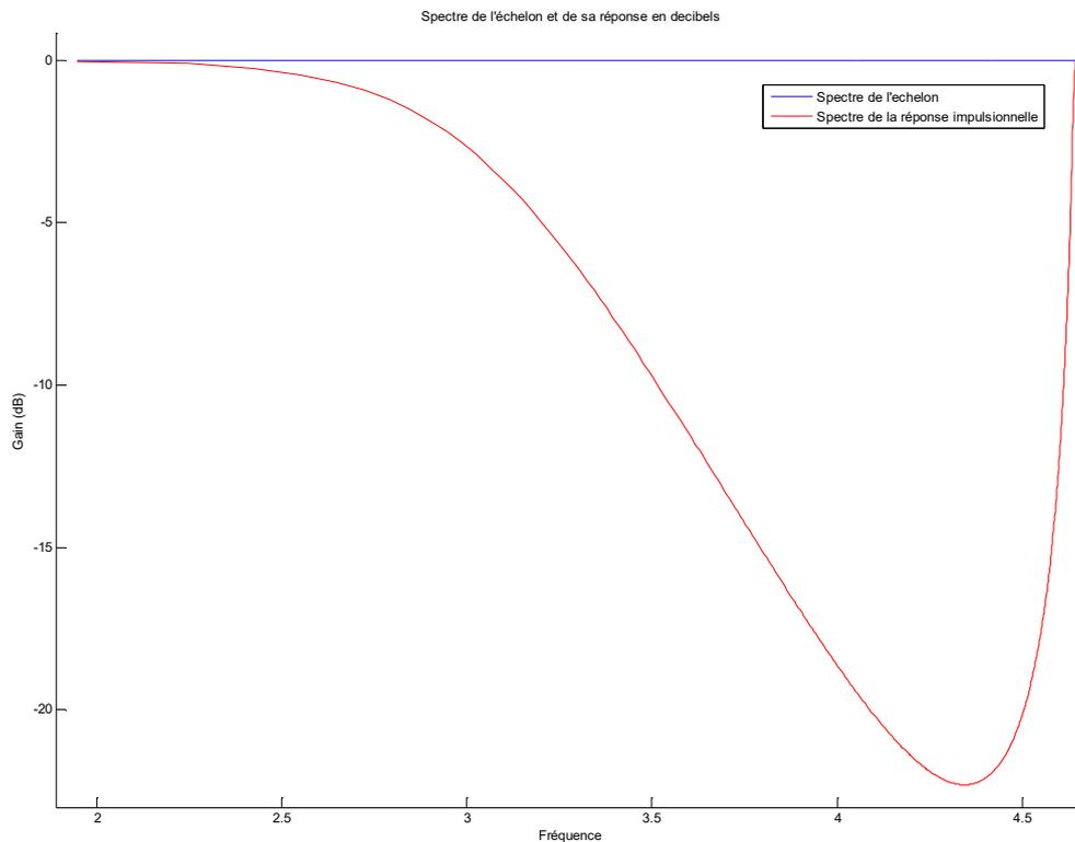
On voit là une nette différence. En effet, le spectre du signal d'entrée est constant car il ne comporte pas de fréquences : il s'agit d'une brusque variation seule. Le spectre du signal filtré par contre, est la caractéristique du filtre. On constate alors qu'il s'agit effectivement d'un filtre passe-bas.
