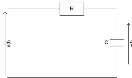
Nous allons chercher à caractériser  $s(t)$  en fonction de  $e(t)$  d'une façon analogique puis numérique.
