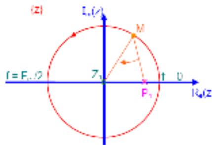
La phase de  $H(f)$  est l'angle indiqué ici en orange, entre les pôles et les zéros, de base M. Son module est l'inverse de la distance PM.
