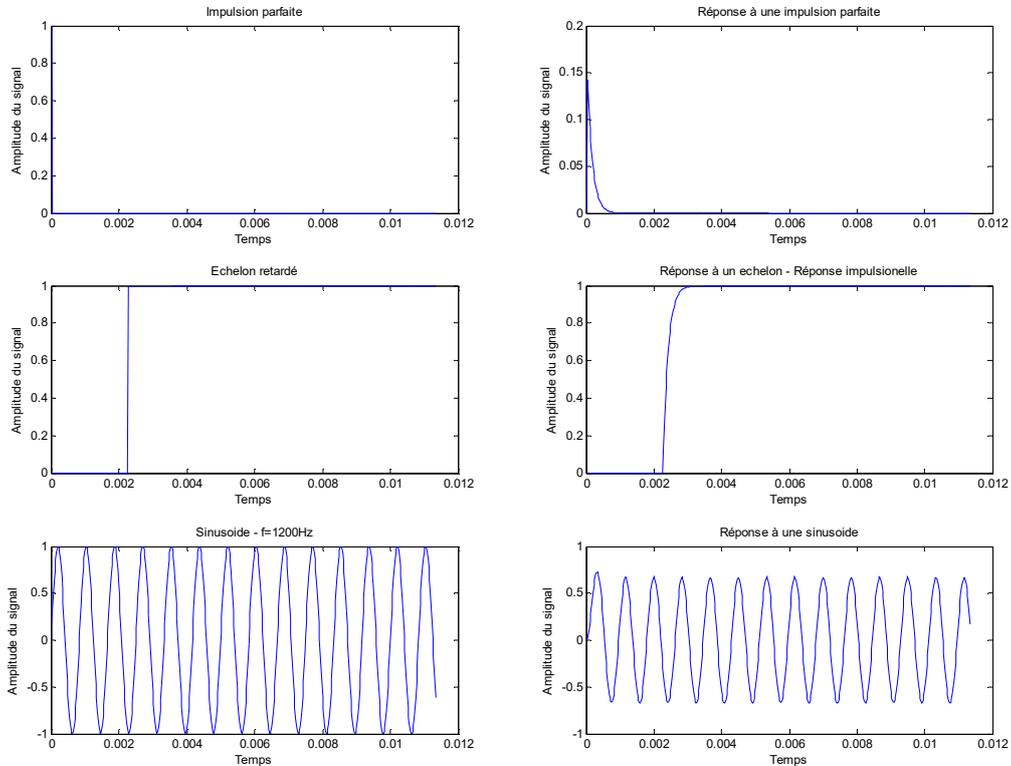
On voit bien que la réponse impulsionnelle est une exponentielle, ce qui concorde avec les résultats théoriques. De plus, il s'agit de la courbe de charge d'un condensateur, ce qui est effectivement le cas (puisque nous étudions la tension aux bornes d'un condensateur dans un circuit RC).
