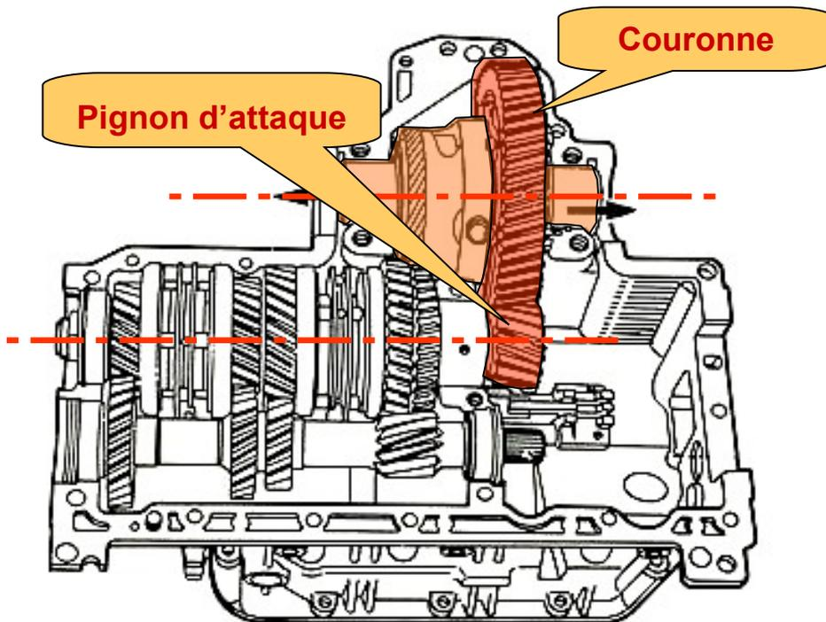
L'arbre de sortie de boîte de vitesses est transversal comme les arbres de roues.
