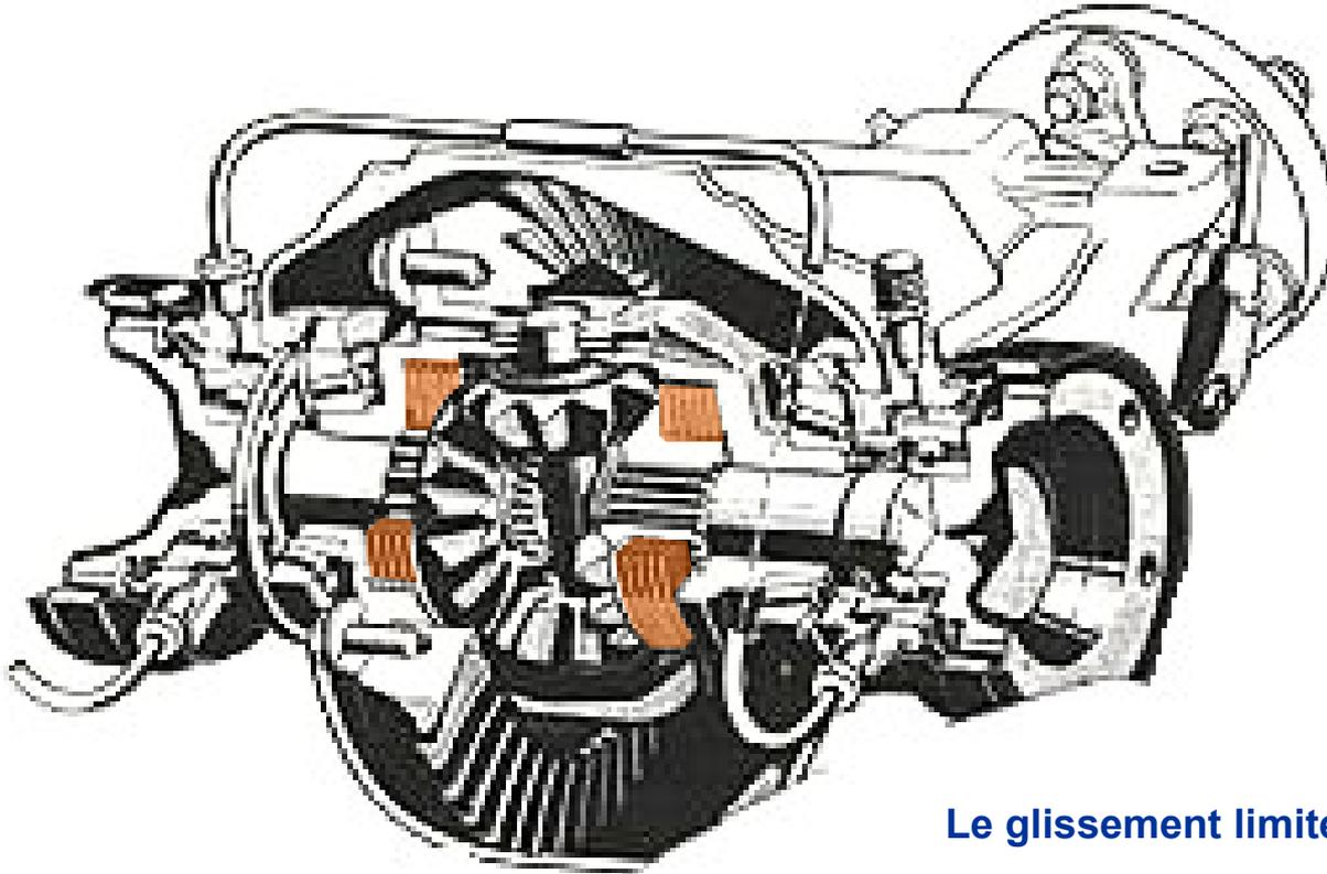
Le glissement limité est obtenu en solidarissant les planétaires avec le boîtier de différentiel grâce à de petits embrayages.
