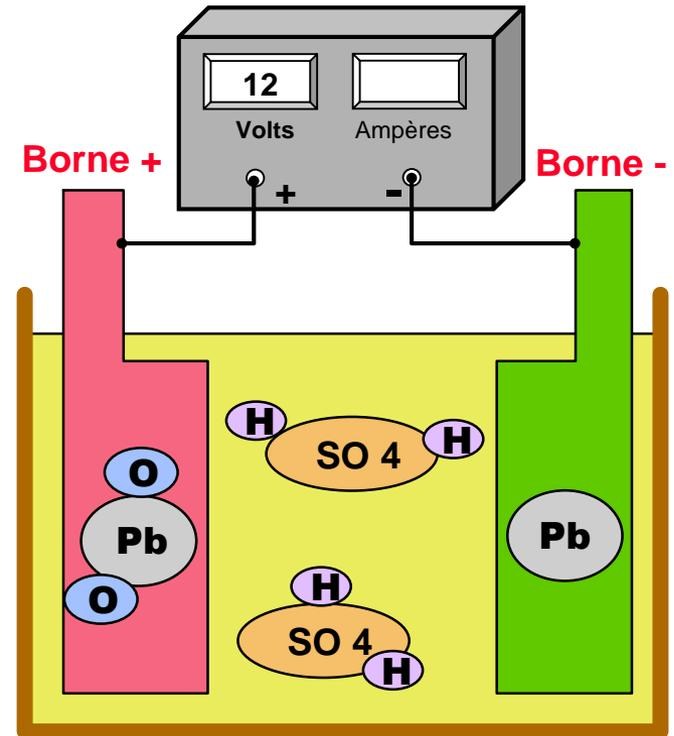
Pour vérifier l'état de charge d'une batterie on peut contrôler la densité de l'électrolyte:
