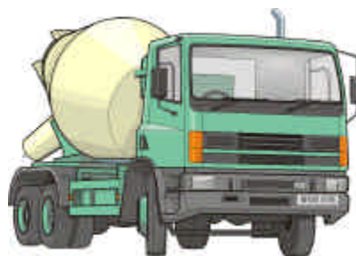
Véhicule peu stable (centre de gravité très haut)
