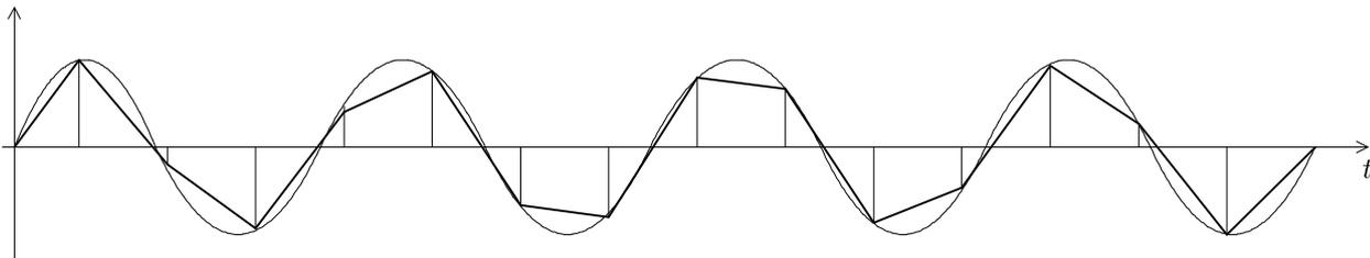
En revanche, si on diminue trop cette fréquence, le signal reconstruit ne ressemble en rien au signal original, et on perd l'information sur la fréquence du signal échantillonné :
