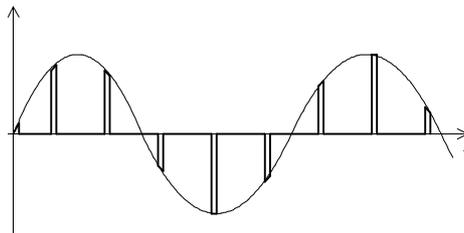
2. **Echantillonneur bloqueur** : entre chaque prise d'échantillon, le signal en aval de l'échantillonneur est maintenu à son niveau au moment du blocage :
