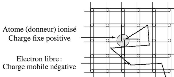
Quatre électrons de la couche périphérique de l'atome pentavalent prennent part aux liens de valence alors que le cinquième, sans attache, est libre de se mouvoir dans le cristal. L'électron libre ainsi créé neutralise la charge positive, solidaire du réseau cristallin, qu'est l'atome pentavalent ionisé.
