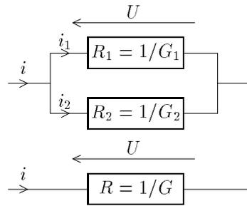
On note leurs conductances respectives  $G_1, G_2$  et la conductance équivalente  $G$ . La loi des nœuds (paragraphe 2.1.3.1) nous permet d'écrire  $i = i_1 + i_2$ . Or on a aussi  $i_1 = G_1 U$  et  $i_2 = G_2 U$ . Il vient donc  $i = (G_1 + G_2) U$ , soit  $G = G_1 + G_2$  :
