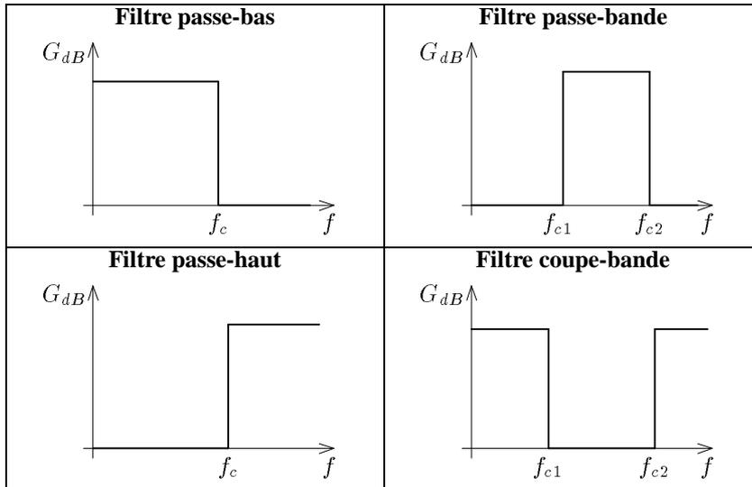
1. **Filtre passe-bas** : la fonction de transfert la plus simple pour un tel filtre est du type
