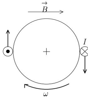
Ce conducteur est soumis de part et d'autre de la pièce cylindrique à une force tangentielle. Ces deux forces opposées créent un couple qui fait tourner l'ensemble.
