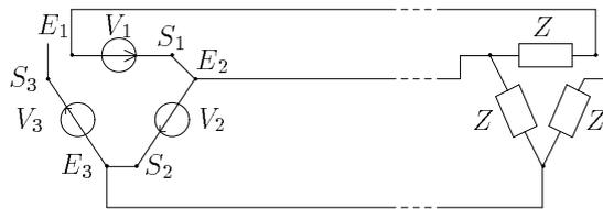
Or  $V_{S_3} - V_{E_1} = (V_{S_3} - V_{E_3}) + (V_{S_2} - V_{E_2}) + (V_{S_1} - V_{E_1}) = V_3 + V_2 + V_1 = 0$ . On peut donc là encore économiser un quatrième fil conducteur, en reliant  $S_3$  et  $E_1$ , ainsi que les points correspondants dans le triangle formé par les impédances  $Z$ .
