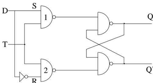
La contrainte est la même que celle de la bascule précédente : en effet, si l'entrée variait alors que  $T=1$ , le temps de propagation dans la porte NON interviendrait, et l'état des sorties ne serait pas défini. Le fonctionnement de cette bascule est en fait très simple, puisqu'il ne s'agit que d'une « propagation » de l'information. Quand  $T=1$ ,
