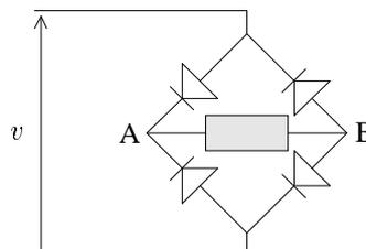
Il s'agit en fait de la combinaison de deux redresseurs demi-onde : un à cathode commune, dont le point commun est A (cf. le schéma donné en exemple du redresseur demi-onde), et un à anode commune, dont le point commun est B. La différence de potentiel aux bornes de la charge,  $V_A - V_B$ , se calcule en remarquant que  $V_A$  est donné par un montage à cathode commune, et  $V_B$  par un montage à anode commune. La tension redressée aux bornes de la charge est donc la suivante :
