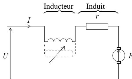
Les courants  $I$  et  $I_e$  ne sont plus indépendants, mais il est encore possible de régler le flux en ajoutant un rhéostat en parallèle sur le bobinage inducteur.
