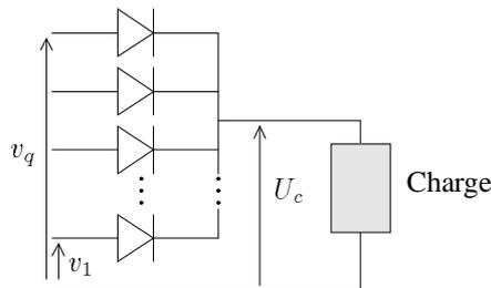
Dans ce dispositif, une seule diode conduit à un instant donné (celle dont le potentiel d'anode  $v_k$  est le plus élevé). Les autres sont bloquées. On dit que ce montage est à *cathode commune*.
