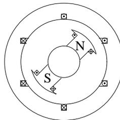
Le champ tournant ainsi créé entre le stator et le rotor (cf. théorème de Ferraris, paragraphe 7.3.1.2) induit des courants dans les bobinages du rotor. Si d'autre part le rotor tourne (car par exemple une autre machine est montée sur le même arbre, fonctionnant en moteur), les spires portées par le rotor vont voir un champ tournant résultant de la combinaison :
