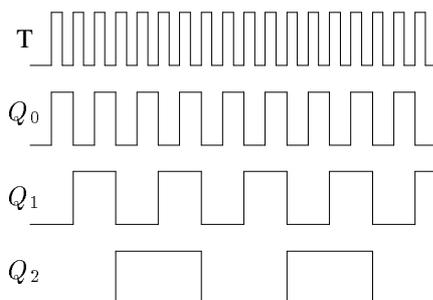
5.12. Notez qu'alors le passage au zéro de la sortie du compteur permet de définir une nouvelle période par rapport à celle de l'horloge : la fréquence de cette dernière est divisée par  $2^m$ .
