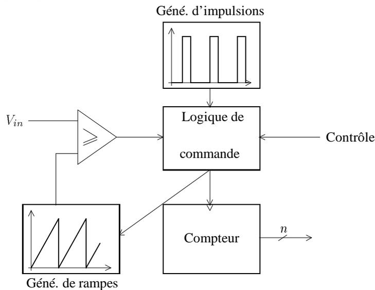
Les signaux de contrôle déclenchent le début de conversion. La logique de commande met en marche le générateur de rampes. La sortie de celui-ci est comparée à la tension à convertir. Tant qu'elle lui reste inférieure, la sortie du comparateur reste à 1 par exemple, et la logique de commande transfère le signal du
