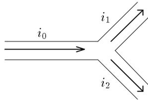
Les électrons venant de la « gauche » partiront soit dans la première, soit dans la deuxième branche. Mais le nombre total d'électrons par seconde restera le même que celui qui arrive en permanence par la gauche, et donc  $i_0 = i_1 + i_2$  (avec les sens des courants définis suivant la figure précédente).
