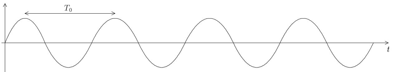
Si  $f_e$  est grande devant la fréquence de la sinusoïde, comme sur le schéma suivant,
