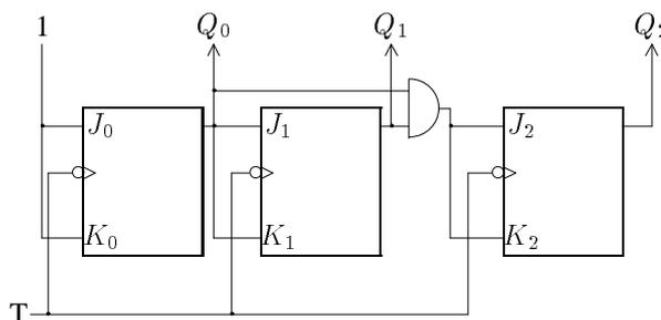
L'horloge est appliquée de façon synchrone sur les entrées d'horloge de toutes les bascules :
