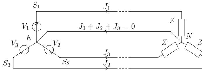
Il apparaît que le quatrième conducteur, où circule le courant  $J_1 + J_2 + J_3 = 0$ , peut être supprimé. Lorsqu'il existe, ce conducteur est appelé *fil neutre*, mais il est important de retenir que dans le cas où le système est *équilibré*, les points E et N sont au même potentiel, qui est le potentiel du neutre, identique pour tous les « N » du même réseau, qu'ils soient explicitement reliés entre eux ou non.
