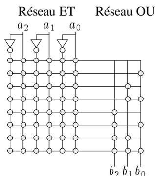
Dans le schéma d'un PAL à 3 bits ci-dessus, les cercles indiquent des fusibles, *ie* des points où les connexions peuvent être établies ou non. La programmation est réalisée en appliquant des différences de potentiel capables de « claquer » ces fusibles, et la déprogrammation en exposant le réseau à des ultraviolets qui les « régénèrent ».
