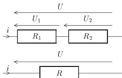
La loi des mailles (paragraphe 2.1.3.2) nous permet d'écrire  $U = U_1 + U_2$ . Or on a aussi  $U_1 = R_1i$  et  $U_2 = R_2i$ . Il vient donc  $U = (R_1 + R_2)i$ , soit  $R = R_1 + R_2$  :
