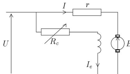
Les courants  $I$  et  $I_e$  sont indépendants. Le rhéostat <sup>7.12</sup>  $R_c$  permet de régler  $I_e$  et donc le flux dans l'inducteur.
