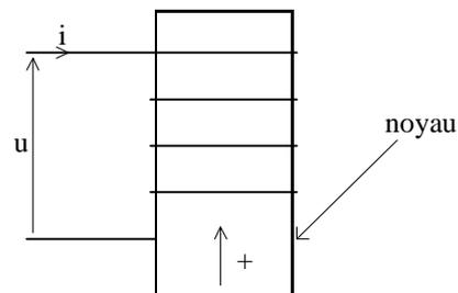
Il faut déterminer des conventions de signes pour les grandeurs algébriques intervenant dans la bobine. On choisit *arbitrairement* le sens positif pour le champ magnétique créé dans le noyau. L'orientation de  $i$  est alors définie de telle sorte que  $i > 0$  crée un champ magnétique positif. L'orientation de  $u$  est telle que  $(u, i)$  correspond à une
