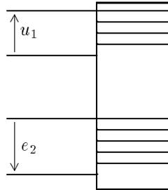
Un transformateur statique se composera donc d'un circuit magnétique sur lequel sont bobinés deux enroulements distincts.
