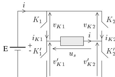
Chaque interrupteur est en fait composé d'une diode et d'un thyristor placés en parallèle :
