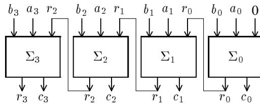
Cet additionneur est simple à construire, mais peu performant car la retenue doit être « propagée » d'un bloc à l'autre.
