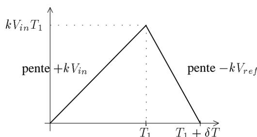
Il suffit de mesurer le temps de retour au zéro  $\delta T$  pour avoir une mesure proportionnelle à  $V_{in}$  :  $\delta T = \frac{T_1}{V_{ref}} V_{in}$ . Ce convertisseur est peu coûteux, remarquablement insensible au bruit, mais est très lent ce qui le rend inadapté à l'acquisition rapide de données. En revanche, ce principe de fonctionnement est utilisable pour des appareils de mesure.
