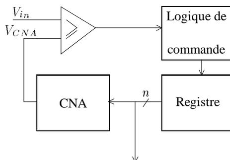
Le CNA est un convertisseur numérique/analogique. On calcule les bits par comparaisons successives, en partant du bit de plus fort poids. Par exemple, prenons un tel convertisseur sur 4 bits (faible précision), conçu pour convertir des tensions de 0 à 10V (on dit alors que la *pleine échelle* est de 10V), et supposons qu'il ait à convertir 2,9V. Le pas d'échantillonnage vaut  $10/2^4 = 0,625V$ . La sortie du comparateur vaut 1
