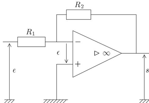
On a  $\epsilon = 0$ , et  $i_+ = i_- = 0$ . En appliquant le théorème de Millman (cf Annexe B, paragraphe B.2), comme  $V_+ = V_- = 0$ , il vient :
