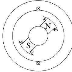
On a représenté sur ce schéma une situation où l'induit ne porte qu'une spire. L'inducteur (aimant permanent ou bobine alimentée par un courant continu  $I_e$ ) crée un champ d'induction magnétique dans l'entrefer, champ dont on a représenté sur le schéma précédent les pôles nord et sud. Un flux  $\Phi$  est donc lui aussi induit et son mouvement de rotation à la vitesse angulaire  $\omega$  crée dans la spire de l'induit une f.é.m (plus ou moins approximativement) sinusoïdale. On peut :
