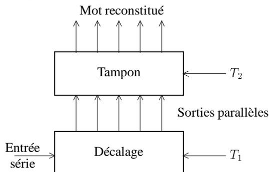
Dans cet exemple, la fréquence de l'horloge 2 doit être le cinquième de celle de l'horloge 1.
