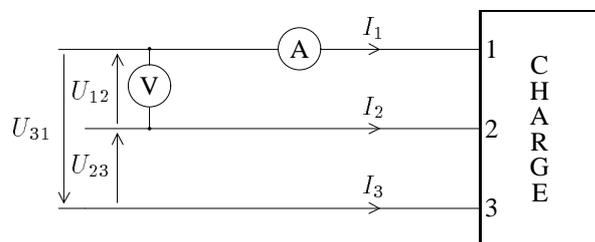
Les symboles  $\textcircled{A}$  et  $\textcircled{V}$  désignent respectivement un ampèremètre et un voltmètre, mesurant courant et différence de potentiel. On appellera dans la suite du cours :
