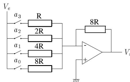
Il est facile de vérifier que  $V_s$  vérifie  $V_s = -V_e \sum_{i=0}^3 a_i 2^i$ . La précision de ce convertisseur simple est limitée par celles sur  $V_e$  et les résistances.
