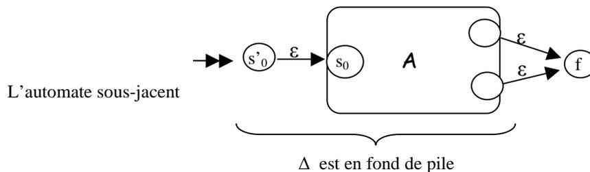
Le symbole initial de pile  $\Delta$  restera en fond de pile jusqu'à l'arrivée en  $f$ , ce qui garantit que la pile restera non vide. Le symbole en haut de la pile signale laquelle des transitions  $([i, P], a, [j, QP])$  peut se substituer à  $([i, \varepsilon], a, [j, Q])$  : ce symbole est dépilé, puis remis sur la pile, puis  $Q$  est empilé (cf. Chap. 1, §1.4., Remarque 2).
