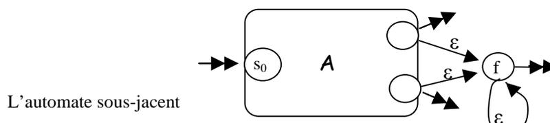
L'automate  $A' = (\Sigma, E \cup \{f\}, s_0, F \cup \{f\}, \Gamma, \delta')$  ainsi obtenu reconnaît, par état acceptant et pile vide, le langage reconnu par  $A$ .
