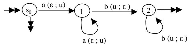
Un automate à pile peut se décrire aussi à l'aide d'une table dans laquelle les transitions sont spécifiées. Les lignes correspondent aux états, les colonnes aux étiquettes possibles. Dans les cases figurent les triplets (état d'arrivée ; symbole dépilé ; symbole empilé) ; il peut y en avoir plusieurs par case, ou aucun. Les états particuliers sont signalés dans les dernières colonnes.
