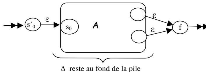
Une fois mis dans la pile, le symbole  $\Delta$  ne peut pas être dépilé par des transitions de  $A$ . Il est dépilé par les nouvelles transitions aboutissant à  $f$ . La pile n'est vide qu'aux états  $s'_0$  (initial) et  $f$  (acceptant).
