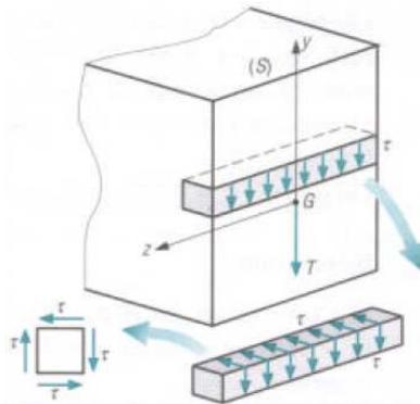
La figure ci-contre donne la distribution des contraintes de cisaillement dans une section droite (S) supportant un effort tranchant T.
