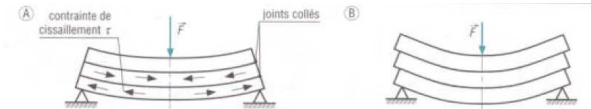
Pour l'exemple ci-dessus, les contraintes de cisaillement  $\tau$  qui s'exercent dans les joints collés assurent le maintien (évitent le glissement) entre les poutres respectives et limitent ainsi les déformations.
