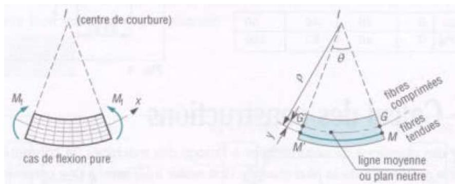
La ligne moyenne  $GG'$  ne subit ni allongement ni raccourcissement (contraintes  $\sigma$  nulles). Pour la figure proposée, les fibres situées au-dessus de la ligne neutre sont comprimées et supportent des contraintes de compression ; celles situées au-dessous ( $MM'$ ) sont tendues et supportent des contraintes de traction.
