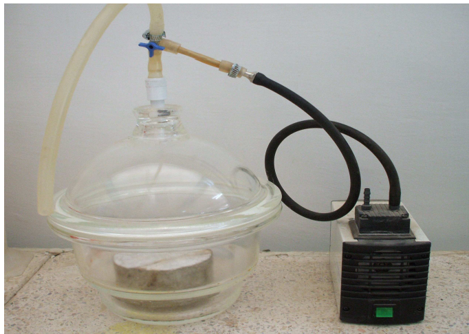
Photo IV-2 : Saturation sous vide (Dessiccateur – Pompe à vide)
