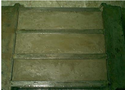
Photo 3.7 : Eprouvettes de coulis de ciment
