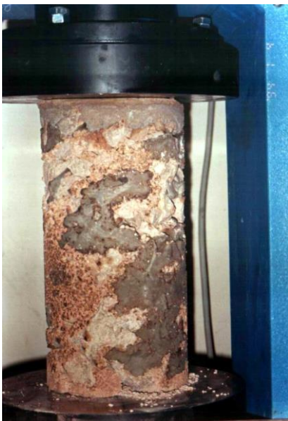
Photo 3.25 : Epreuve injectée coulis de ciment
