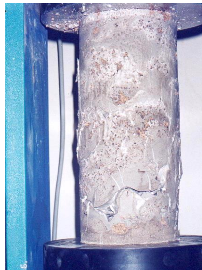
Photo 3.26 : Epreuve injectée coulis de ciment+chaux
