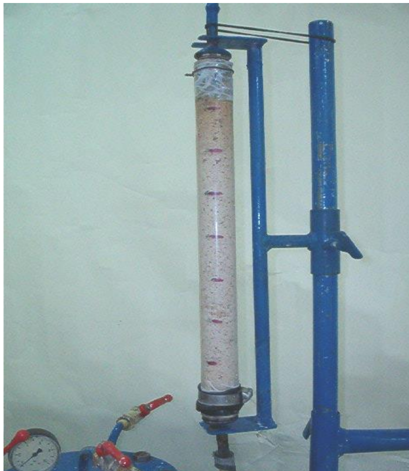
Photo 3.6 : Coulis injectable Coulis de chaux ( E/C_x = 1.9 )
