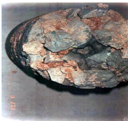
Photo 3.25 : Epreuve injectée coulis de ciment
