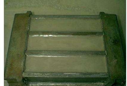
Photo 3.9 : Eprouvettes de coulis de ciment + chaux
