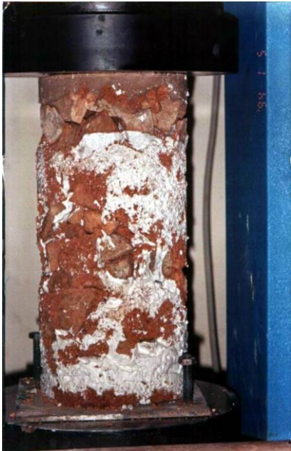
Photo 3.28 : Epreuve injectée (coulis de chaux)
