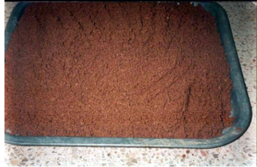
Photo 3.17 : Mortier prêt à l'emploi
