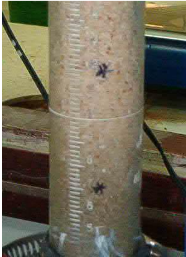
Photo 3.2 : Injectabilité du coulis E/C=0.9
