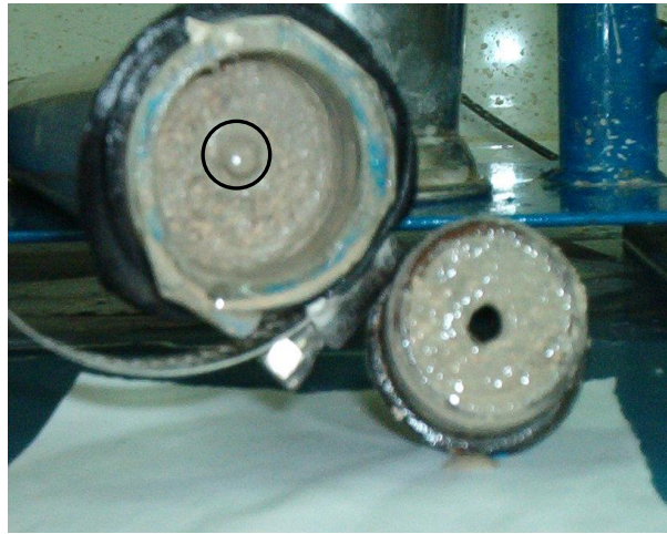
Photo 3.5 : Essorage du coulis de (ciment + chaux)
