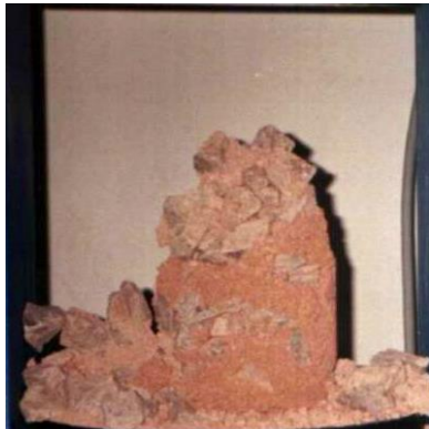
Photo 3.24 : Essai de compression simple (épreuve de référence)
