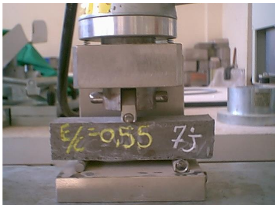
Photo 3.11 : Essai de traction par flexion
