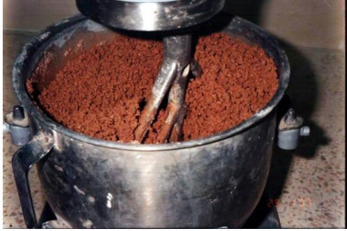
Photo 3.16 : Malaxage du mortier humide
