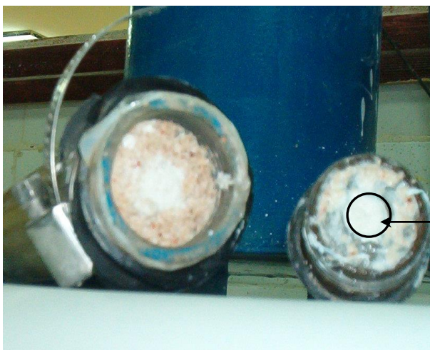
Photo 3.3 : Essorage du coulis de chaux
