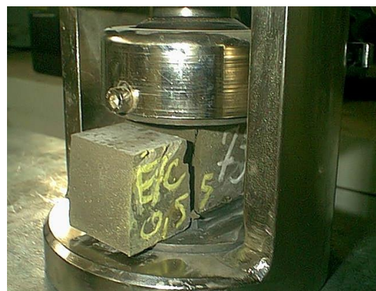
Photo 3.12 : Essai de compression simple
