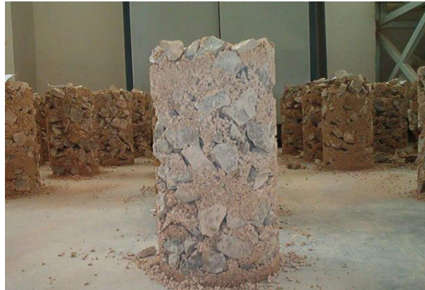
Photo 3.21 : Conservation des éprouvettes
