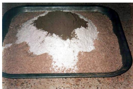
Photo 3.15 : Composants du mortier sec
