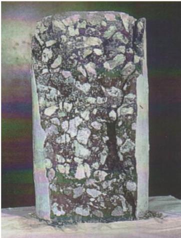
**Figure 2.13 :** Epreuve de remplissage
