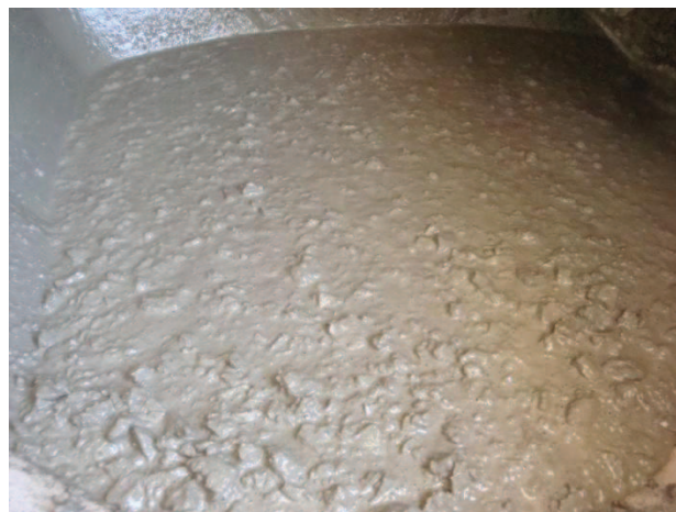
Figure 4.2b : Aspect apparent d'un béton plastique.
