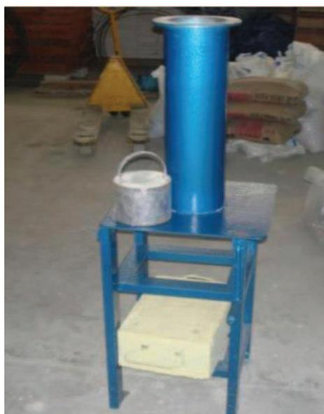
**Figure 3.2** : Dispositif de mesure de la compacité expérimentale.
