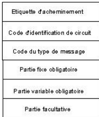
Figure 2.16 : Structure d'un message TUP
