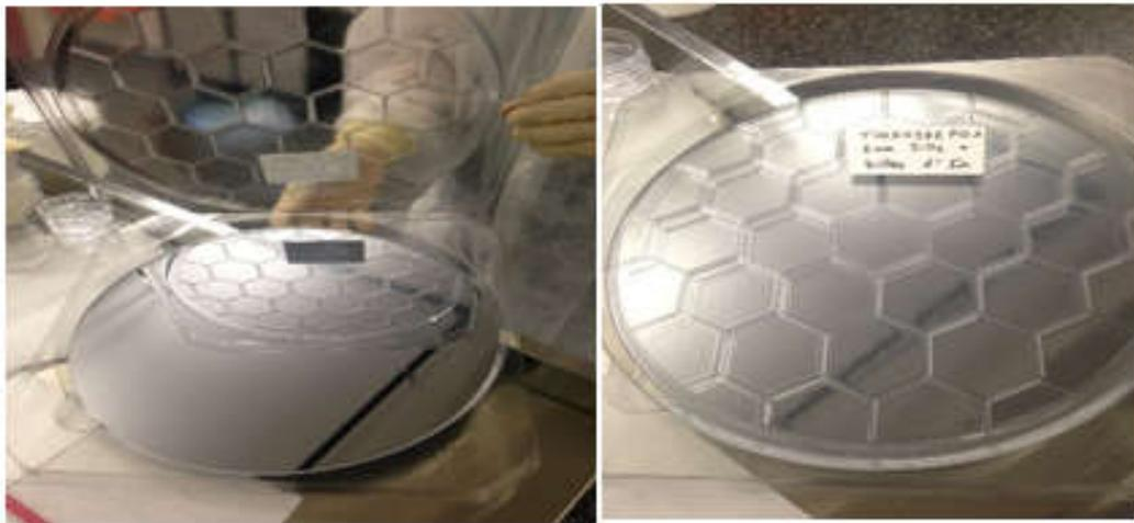
**Figure 15: Nouvelles plaques constituées de : Silicium + 2nm de  $\text{SiO}_2$  + nanostructures d'indium**
