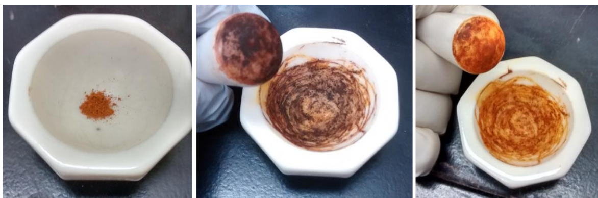
Figure 45 : Composé 2 à l'état initial (gauche), pressé à l'aide d'un pilon et d'un mortier (centre), après exposition à des vapeurs de solvant (droite).
