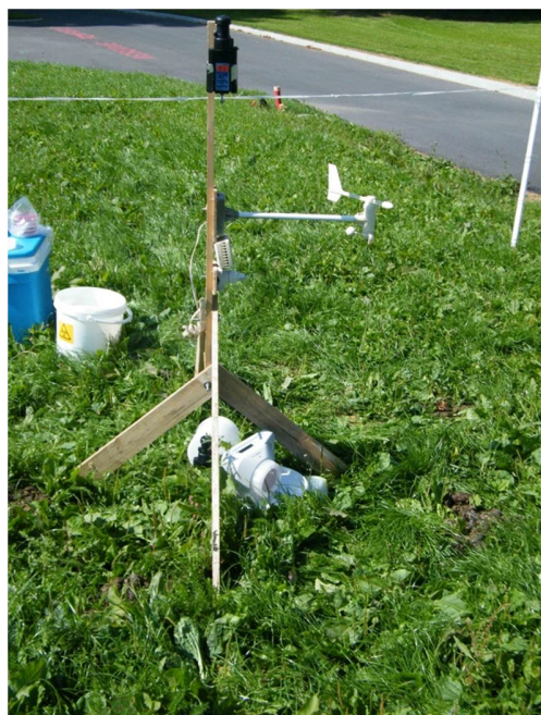
Photographie n° 17: Les prélèvements en cours. L'Air idéal®3P collectant l'air à 15 cm du sol et les deux CIP 10 MR, l'un posé au sol et l'autre fixé sur la potence à 1,15 m de hauteur
