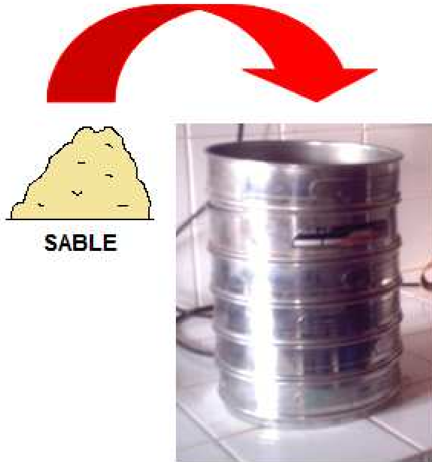
Photo II.14 : Versement de l'échantillon dans le tamis supérieur
