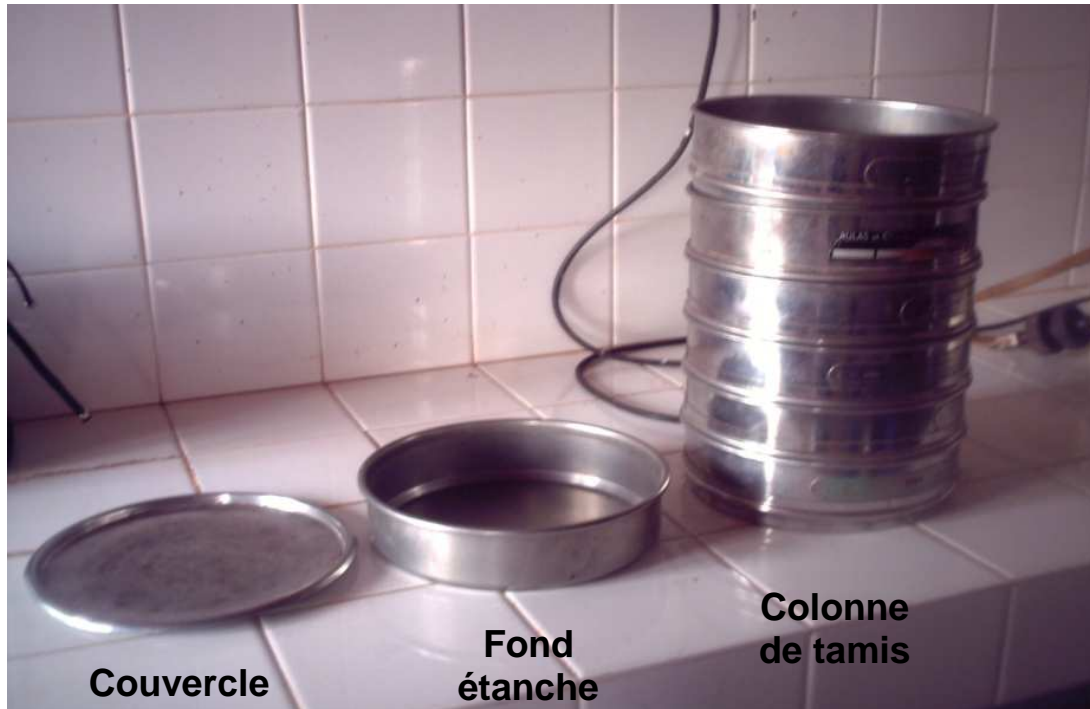
Photo II.12 : Emboîtement des tamis utilisés
