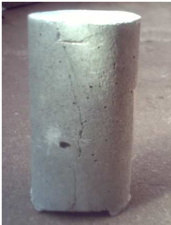
Photo II.24 : Eprouvette après un essai de compression
