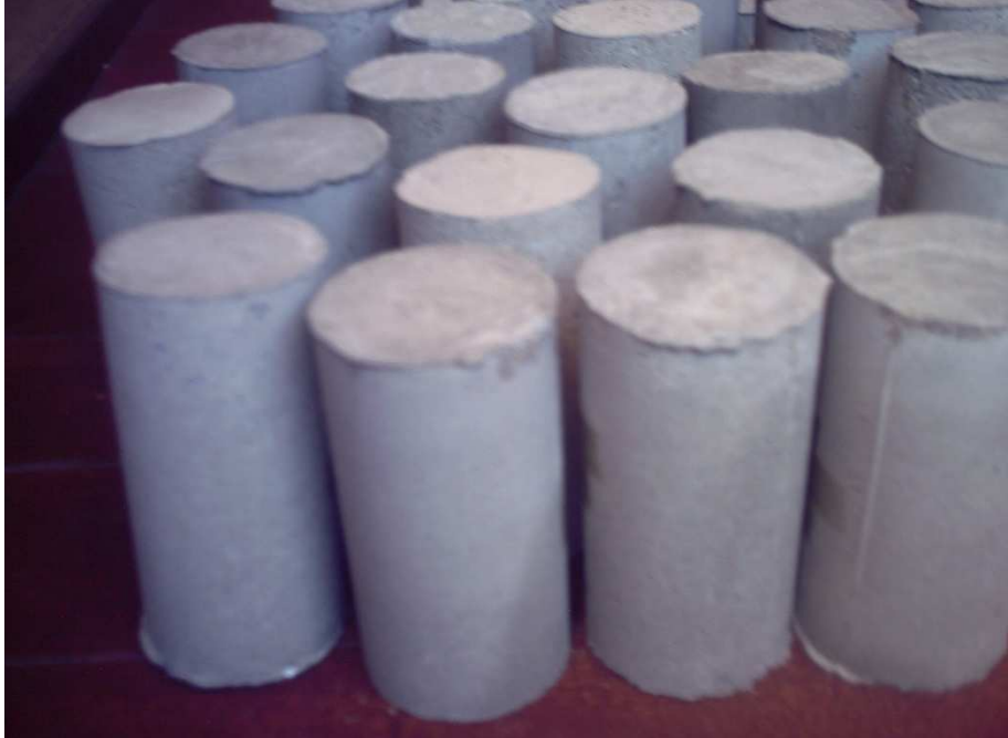
Photo II.18 : Les éprouvettes avec h = 2d = 94 \text{ mm}
