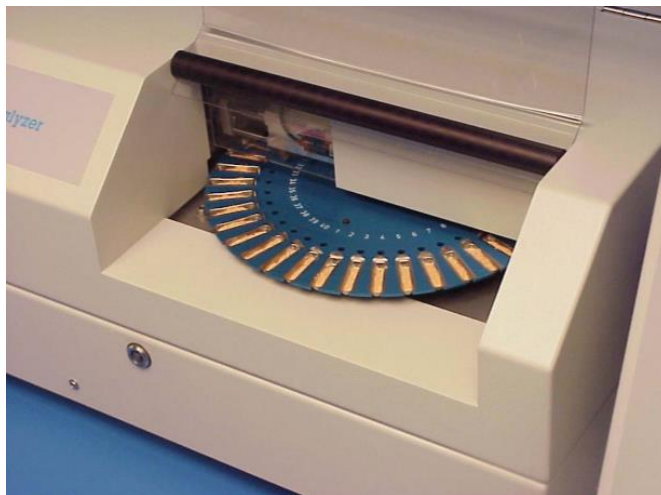
Figure 14: Passeur d'échantillons solides et/ou liquides intégré
