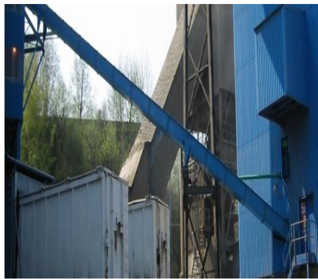
Figure 6: Convoyeur à chaîne (Redler).
