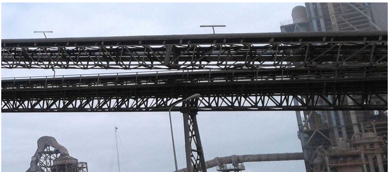
Figure 13: Le convoyeur à bande horizontale
