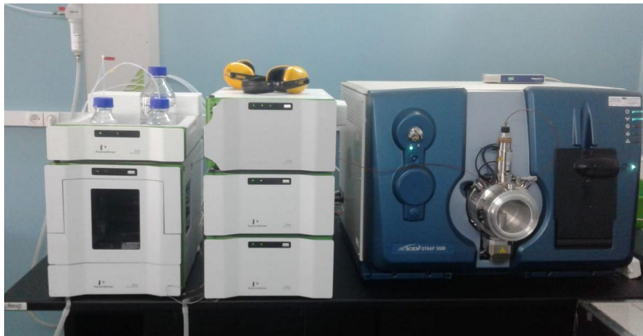
Figure 12 : Chromatographie en phase liquide couplée à la spectrométrie de masse tandem (AB SCIEX 5500 QTRAP)
