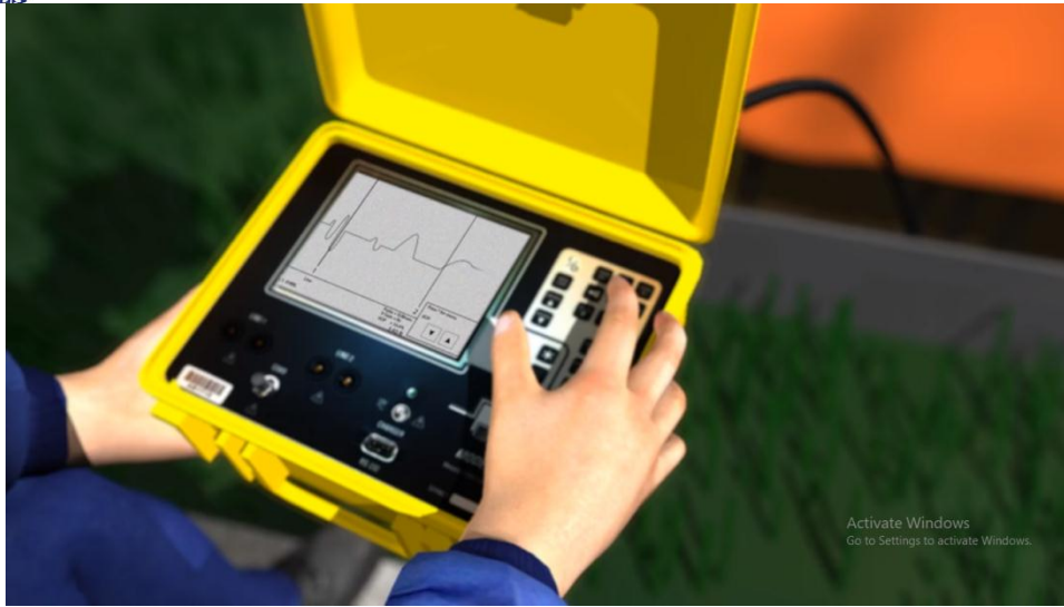
Figure 29 : Vérification de la longueur et du défaut de câble à l'aide du DTR
