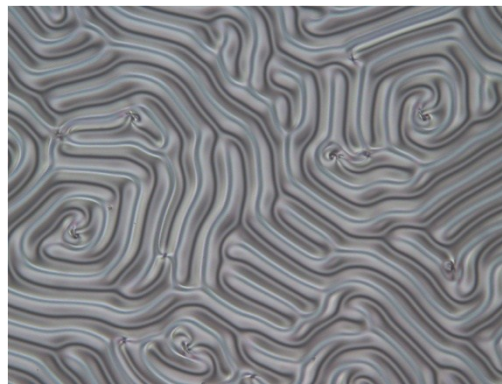
Figure 4.41 : Structure d'orientation nommée fingerprint de cristaux liquides cholestériques
