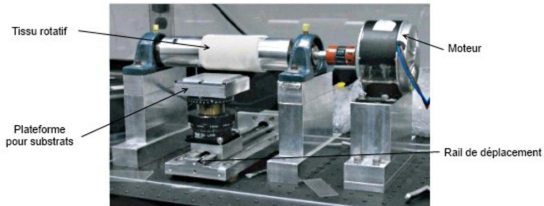
**Figure 2.13 :** Montage rotatif pour frottement mécanique
