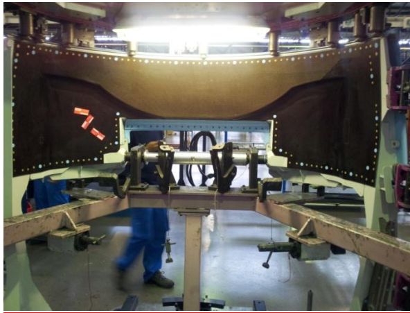
Figure 28 : Vue globale de la structure arrière sur bati
