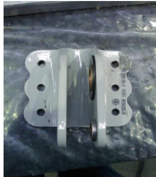
Figure 37 : Ferrure servant au perçage de la contre ferrure
