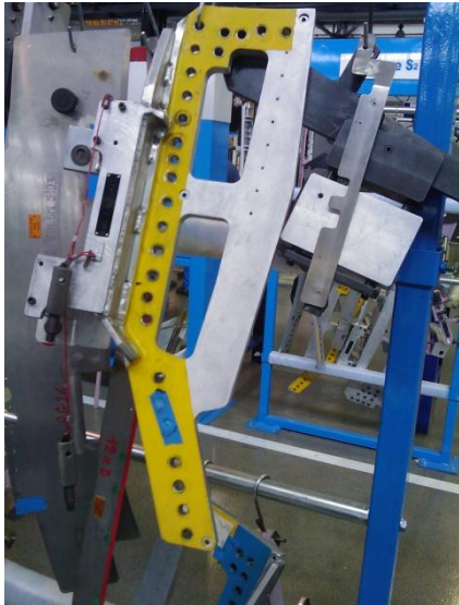
Figure 57 : outillage sujet au TIR LASER sur station 2
