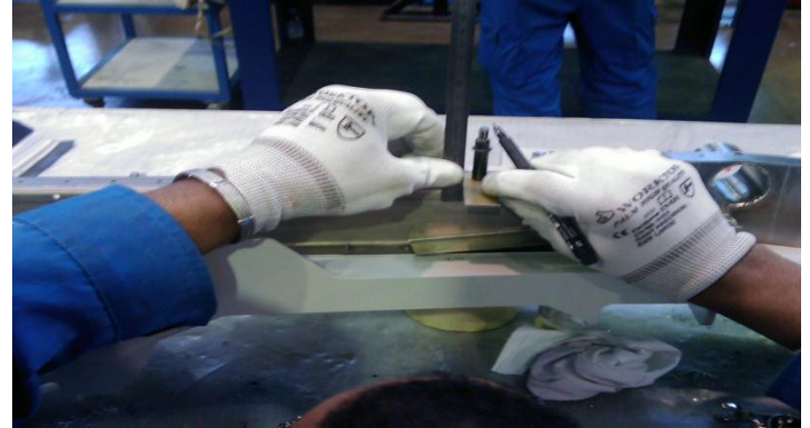
Figure 46 : Traçage avant de procéder au perçage
