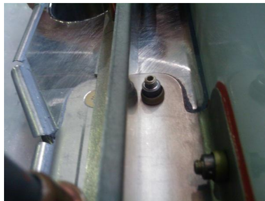
Figure 48 : Résultat : La fixation ne touche pas la pièce tout en gardant un trusquinage conforme
