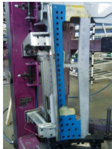
Figure 34 : Outillage positionné sur le bâti à l'aide des broches
