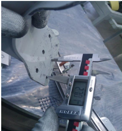
Figure 31 : Vérification des mesures sur les Bumpers
