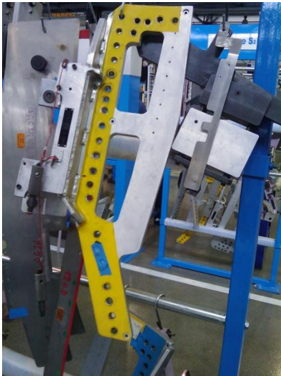
Figure 33 : Outillage servant aux perçages des zones à entraxe non conforme
