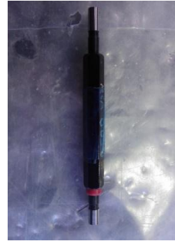
Figure 17 : Tampon lisse double de contrôle diamètre
