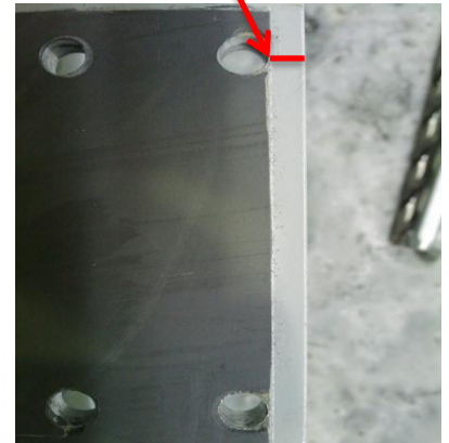
Figure 36 : Problème de trusquinage sur contre ferrure
