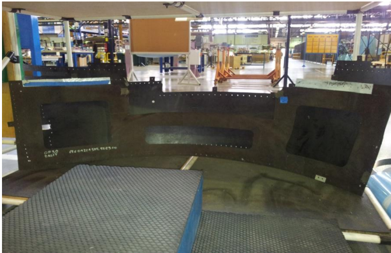
Figure 55 : Masque de perçage pour revêtement interne sur la station 1
