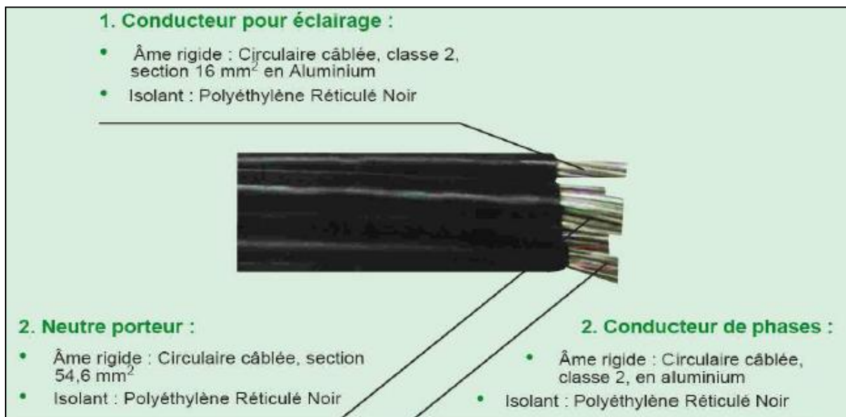
Figure 6 : Câble de distribution
