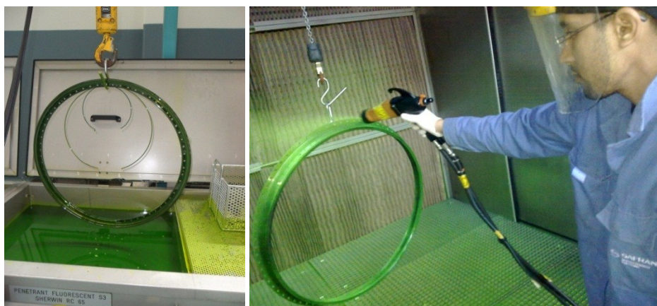
Figure 4-12: Ressuage par trompe et pulvérisation
