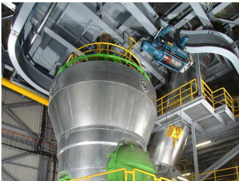
Figure 2-9 : Broyeur Loesche équipé d'un monorail suspendu
