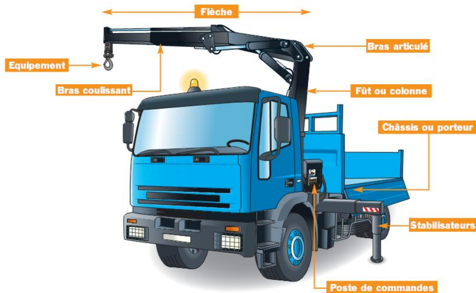
Figure 3-9 : composition d'une grue auxiliaire
